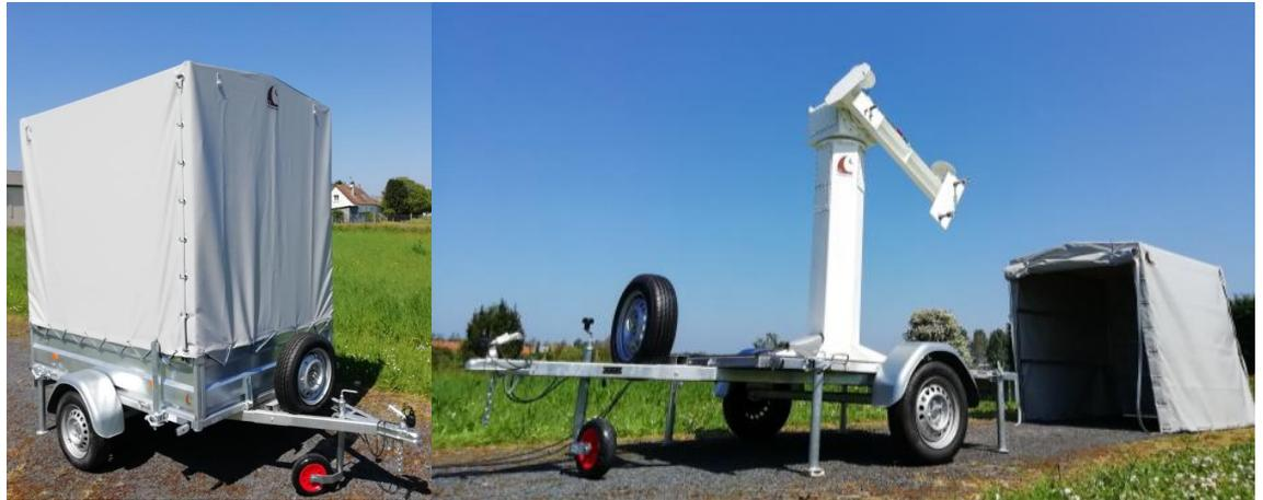
Cette station est conçue pour embarquer un positionneur d'antenne avec un poids total inférieur à 500kg.
