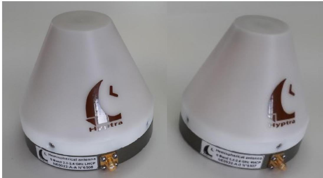
Cette antenne en bande S à été conçu pour fonctionner en polarisation circulaire droite ou gauche.
